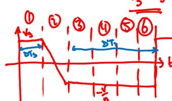
$\langle N_m \rangle_{t_5} = \phi = \frac{1}{t_5} \left[ V_g t_1 + \frac{V_g - V}{2} t_2 + -\frac{V}{n} (t_3 + t_4 + t_5 + t_6) \right]$
