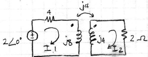
$$\text{Loop 1 : } -2\angle 0^\circ + (4+j8)I_1 - j4I_2 = 0$$
