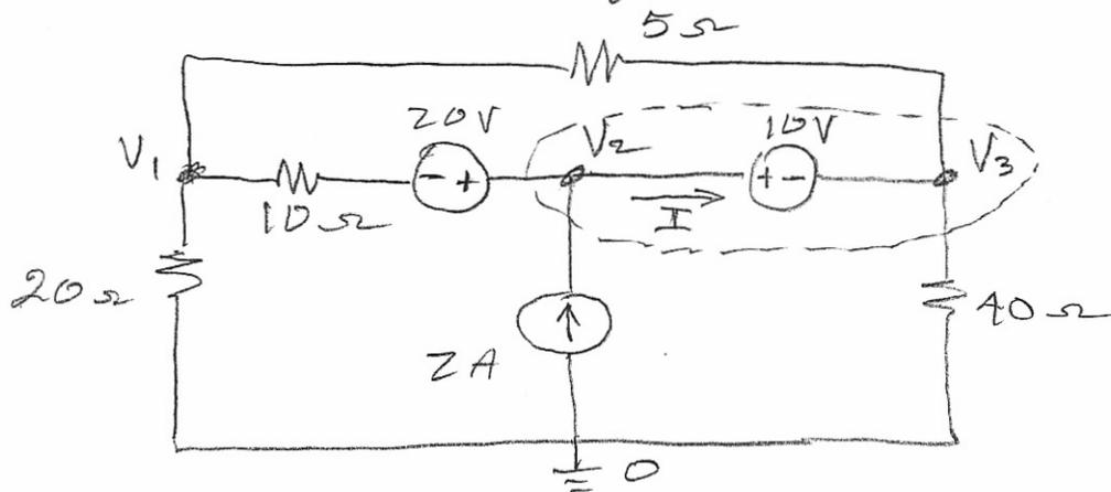
Find  $V_1$ ,  $V_2$ ,  $V_3$  and  $I$ .
