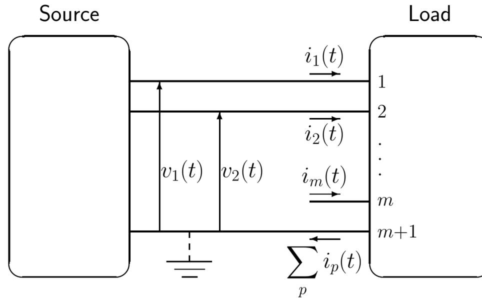
$$v(t) \stackrel{\text{def}}{=} [v_1(t) \quad v_2(t) \quad \dots \quad v_m(t)] \in \mathbb{R}^m$$
