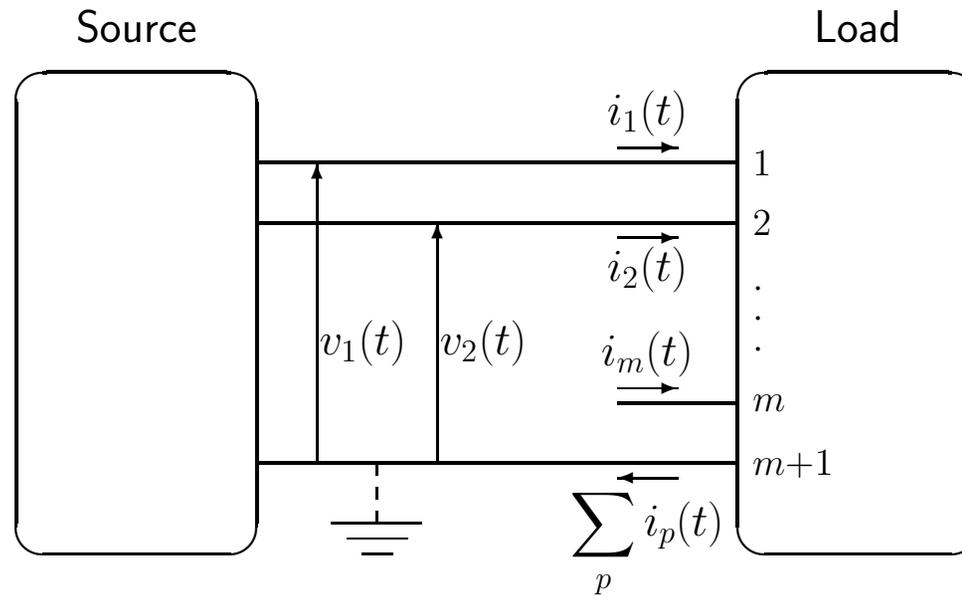
$$v(t) \stackrel{\text{def}}{=} [v_1(t) \quad v_2(t) \quad \dots \quad v_m(t)]$$
