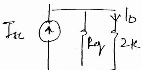
$$I_o = I_{sc} \left[ \frac{R_{eq}}{R_{eq} + 2k} \right]$$
