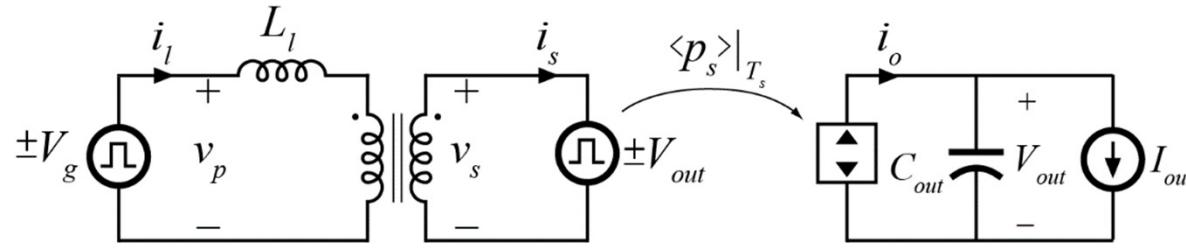
$$\langle i_o \rangle|_{T_s} = \frac{V_g}{n_t L_l T_s} (T_s t_\varphi - 2t_\varphi^2)$$
