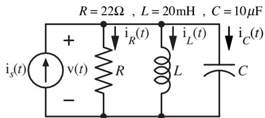
Before time  $t = 0$ ,  $i_s(t) = -1A$ ,  $v(t) = 0V$ ,  $i_L(t) = -1A$ ,  $i_C(t) = 0A$ ,  $i_R(t) = 0A$ .
